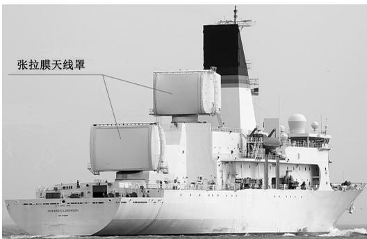
图 1 “洛伦兹”号测量船天线罩
