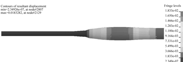
(c) Demarini 垒球棒 (固有频率 = 1393 Hz, 最大振幅 = 18.3 cm)
